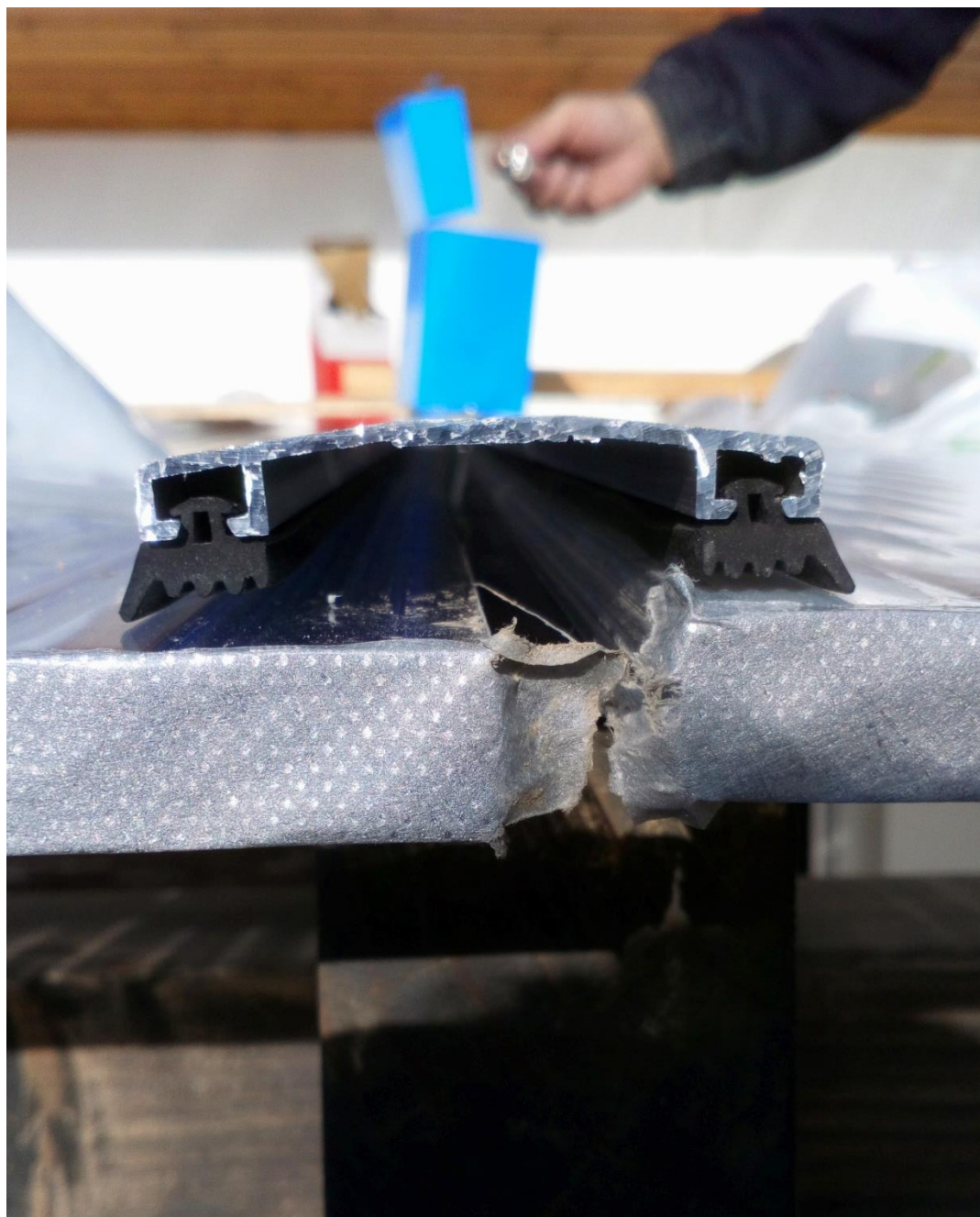
Obrázek 7 Přitlačná krycí lišta s těsněním musí ležet vždy na pevném podkladu
