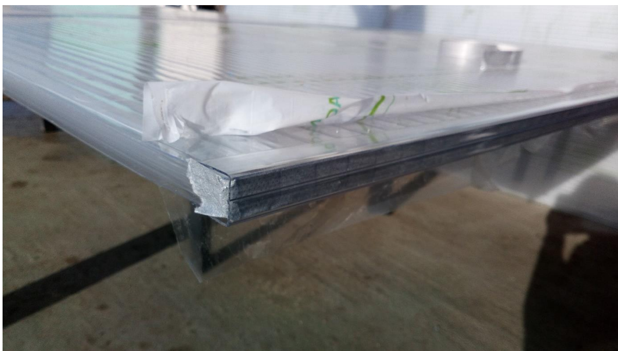
Obrázek 5 Zalepený a zalištovaný kraj desky
